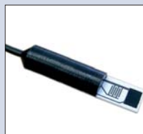
SHSW - Spezialfühler zur Detektion von Benetzung bzw. Wassereintrich. Wasserschalter liefert Signal 1, wenn Wasser detektiert wird und 0 wenn der Sensorbereich trocken ist. Abmessungen: 60 x 10mm
