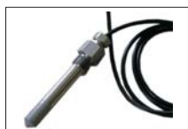
DKRF370-325 - Feuchte-/ Temperaturfühler für Druckluft bis 100bar, G3/8" Gewinde, L=100mm, D=13mm, Einsatz bei -20...+80°C.
