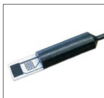
SHS-325 - Spezialfühler zur Messung einsetzender Betauung. Kondensationssensor liefert Signal 1, wenn Benetzung mit Wasser in Folge von Kondensation auftritt. Abmessungen: 60 x 10mm Einsatz 0...50°C
